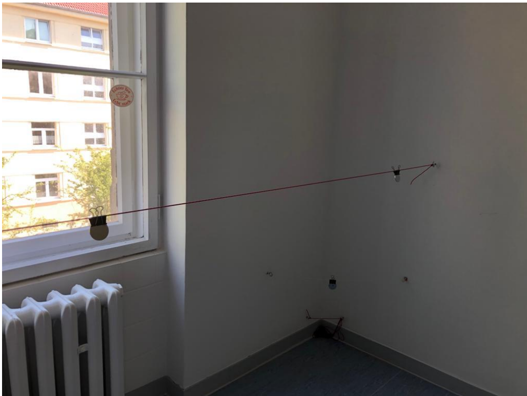
Abb. 2 / Fig. 2: Prüfkörper in 2 m Abstand in 1,20 m Höhe (gleiche Höhe des Testgerätes) / test specimen in 2 m distance and 1.20 m height (same height as the test device)
