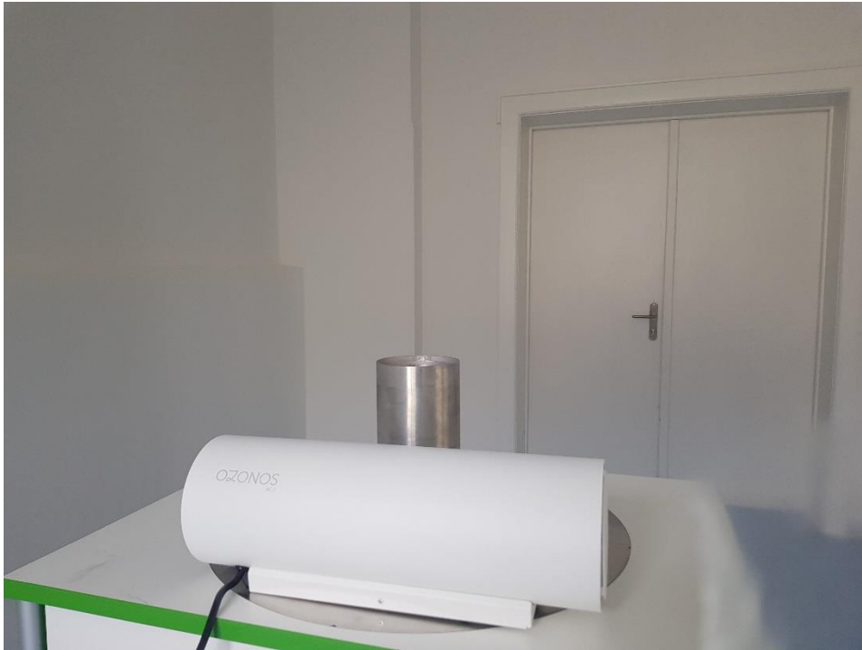
Abb. 1 / Fig. 1: Testgerät im Testraum (73.44 m 3 ) / tested device in the test room (73.44 m 3 )
